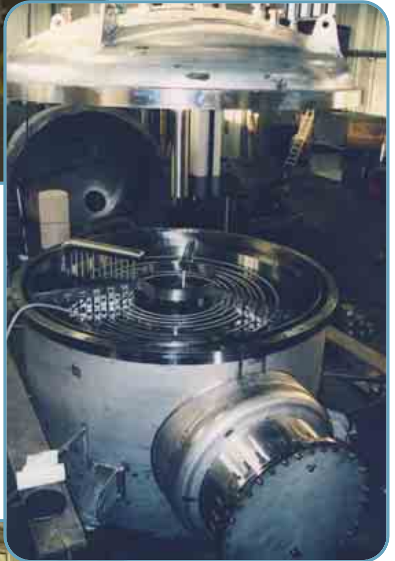
Condenser coil detail - stainless steel 316L P.E.D. Dettagli serpentino condensatore - acciaio inox 316L P.E.D.
